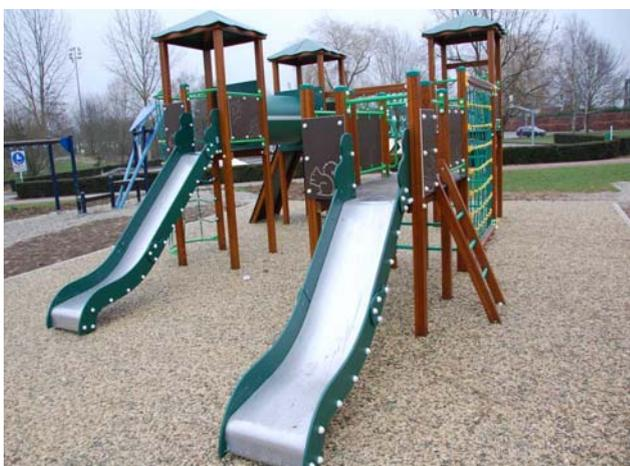
\* une couche de finition en copeaux de caoutchouc souple SECURIMULCH® recyclé, livré en big – bag coloris au choix : brun , vert , rouge, sur une épaisseur standard de 20 mm, est installée sur
